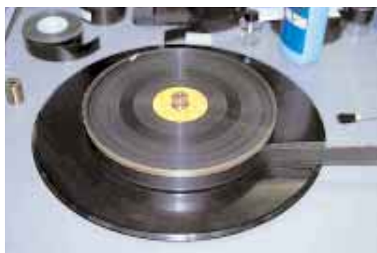
Billede 1: Nitratfilm i opløsning. Den brune farve i spolens yderkant viser at basen er i opløsning. Den klæber allerede en smule sammen. Normalt vil filmen slippe rullen 'kl. 6', men på grund af sammenklæbningen slipper den først 'kl. 4'. Foto: Jesper Stub Johnsen
